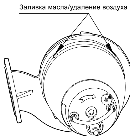
Рис. 18 Отверстия для заливки масла
